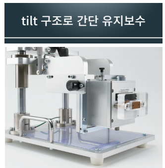
tilt 구조로 간단 유지보수 프레스 유닛을 내쪽으로 일킬 수 있어 프로브 선단의 에어 클리닝 작업을 수월하게 할 수 있습니다.
